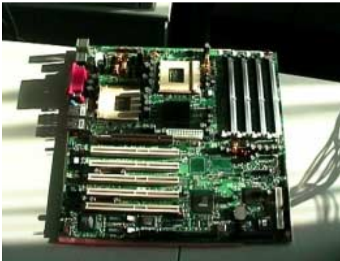
Bild10: 2 Prozessor Dual-Motherboard: ganz oben links die Steckmöglichkeiten nach außen (in rot die parallele Steckdose), zwei Steckplätzen für die Prozessoren, rechts daneben vier Bänke für RAM, in der Mitte der Stecker für das ATX-Kabel, unten fünf Steckplätze für zusätzliche Karten, links davon im Schatten zwei on-board 3-Com-„Karte“, rechts diverse „Weichteile“.
