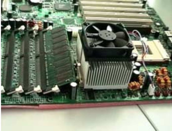
Bild24: Prozessor mit montiertem Kühlkörper und Ventilator (der Prozessor selber ist natürlich darunter versteckt), links RAM-Modul, rechts leerer Steckplatz für einen zweiten Prozessor
