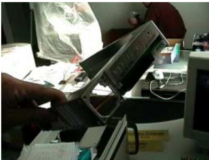
Bild17: Teil des Wechselrahmens für eine von drei einzubauenden Wechselplatten
