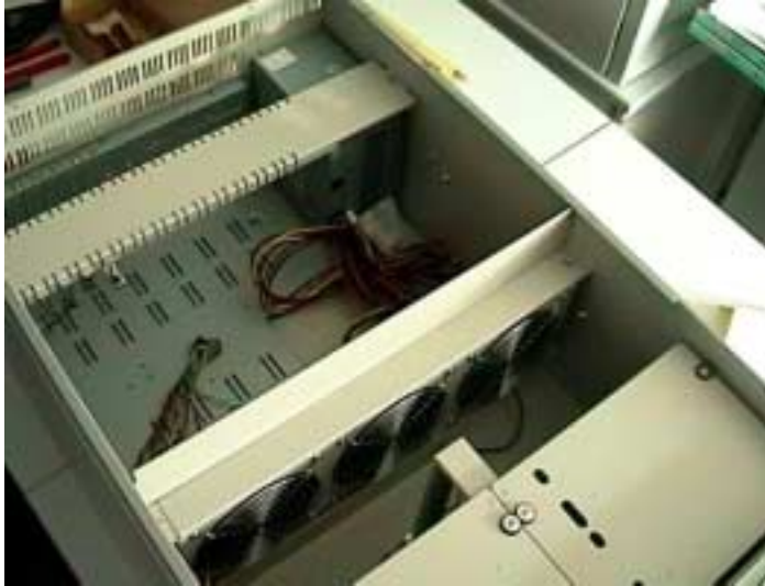
Bild 3: PC-Gehäuse geöffnet mit Ventilatoren unten, Festplattenkäfigen (unten rechts), Netzteil mit Kabeln (oben Mitte).
