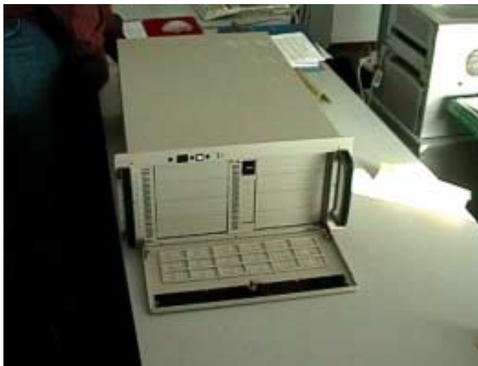
Bild 2: PC-Gehäuse (geschlossen) für Rack-Einbau; vor dem Bau (sieht hinterher fast wieder genauso aus, nur die Lichter leuchten...)
