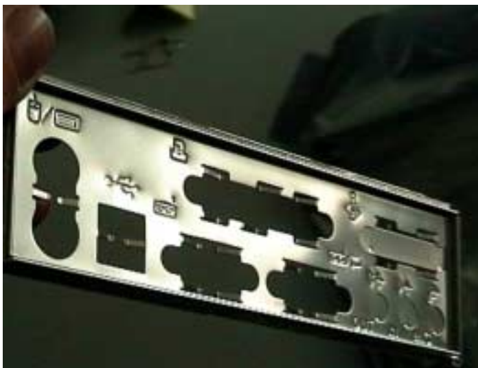
Bild 8: Standard ATX-Blende: links Löcher für Maus/Tastatur, dann zweimal Netzanschlüsse, oben das breite Loch für den Parallel-Anschluss (Drucker), darunter zwei Löcher für serielle Anschlüsse, rechts Löcher für Lautsprecheranschlüsse.
