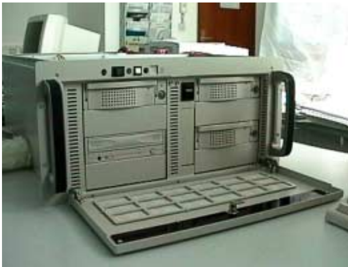
Bild28: Gehäuse mit den eingebauten Wechselrahmen (nachträglich mussten die Platten noch einen Platz tiefer gesetzt werden, da sich die Bügel der Wechselplatte nicht öffnen ließen)
