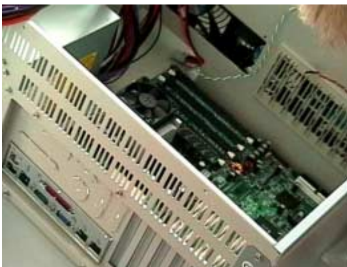
Bild26: Einbau des Boards in das PC-Gehäuse
