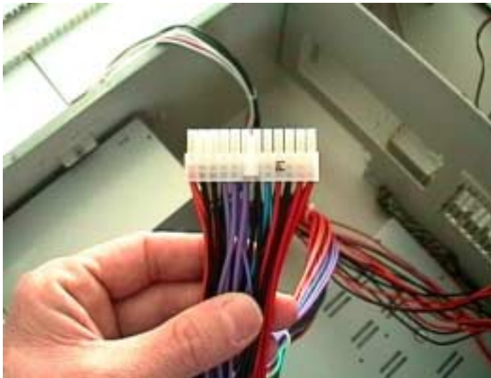
Bild 7: ATX-Stecker (orange 3,3 Volt, rot 12 V, schwarz Masse, lila 5 V)
