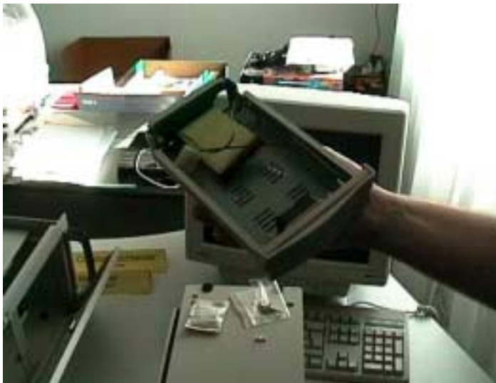
Bild19: geöffnetes Gehäuse, wo die Festplatten eingelegt werden
