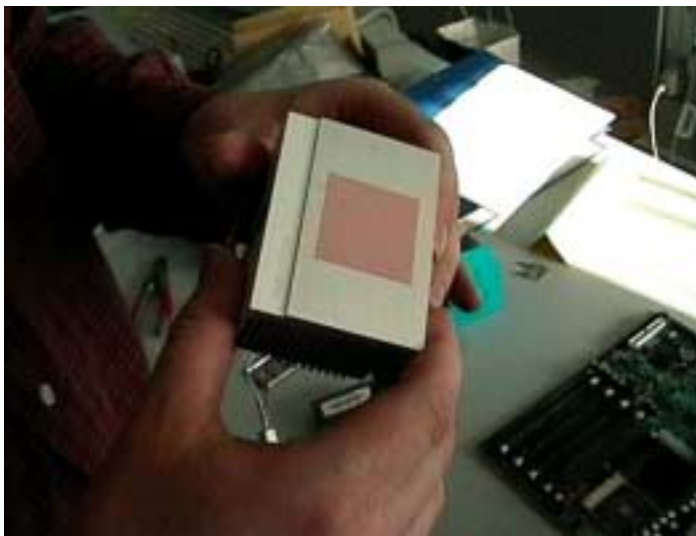
Bild 20: Lüfter für den Prozessor, oben mit Wärmeleitpaste (Hinweis: wehe dem, der den Prozessor startet, ohne dass der Lüfter mit Kühlelement darauf sitzt. Der Prozessor heizt sofort durch bis zur Selbstzerstörung in einem Bruchteil einer Sekunde!)
