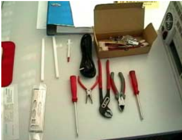
Bild 1: Werkzeug Schrauben, Schraubendreher mit verschiedenen Schlitten und Größen, Kabelbinder (nicht im Bild), Zangen, Kabelschneider, Heißkleber, Kabel
