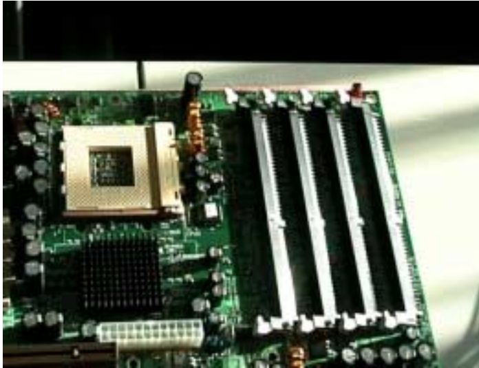
Bild12: Detail auf die Steckplätze für die RAM's, für jeweils 512Mb.
