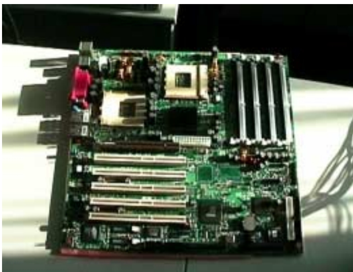
Bild10: 2 Prozessor Dual-Motherboard: ganz oben links die Steckmöglichkeiten nach außen (in rot die parallele Steckdose), zwei Steckplätzen für die Prozessoren, rechts daneben vier Bänke für RAM, in der Mitte der Stecker für das ATX-Kabel, unten fünf Steckplätze für zusätzliche Karten, links davon im Schatten zwei on-board 3-Com-„Karte“, rechts diverse „Weichteile“.
